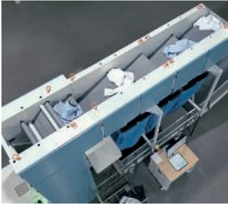
Das neue automatische Sortiersystem von Kannegiesser nutzt u. a. RFID-Technologie.
