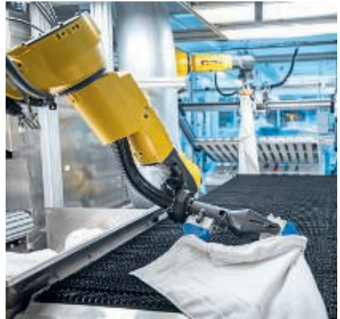
Der Roboter „sewts.VELUM“ gibt Flachwäsche automatisch ein.
